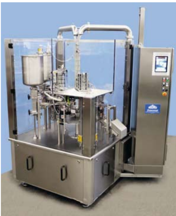
Hochflexibler DOSOMAT 1.1 Pouch-Rundläufer mit schnellem und einfachem Formatwechsel. Ultra-versatile Dosomat 1.1 pouch rotary machine with fast, simple format changeover.
